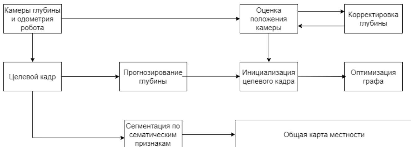
Рисунок 3. Концептуальная схема алгоритма нейросетевой SLAM-навигации
