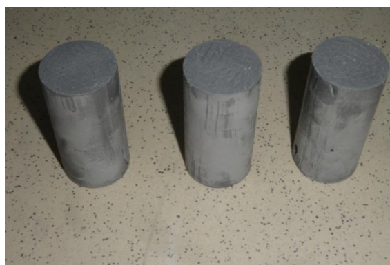
Рисунок 2. Гипсовые образцы для механических испытаний
