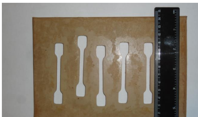
Рисунок 3. Внешний вид формы для изготовления образцов для испытаний на растяжение
